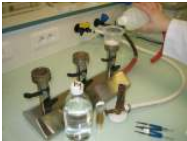
Filtration de 100 ml d'échantillon sur membrane 0,45 µm, puis rinçage avec 50 ml d'eau distillée stérile
